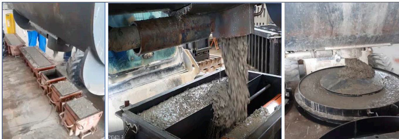
30-32. ábra: Az önjáró Bobcat munkagép sablonokba is üríti a kívánt adagokat
