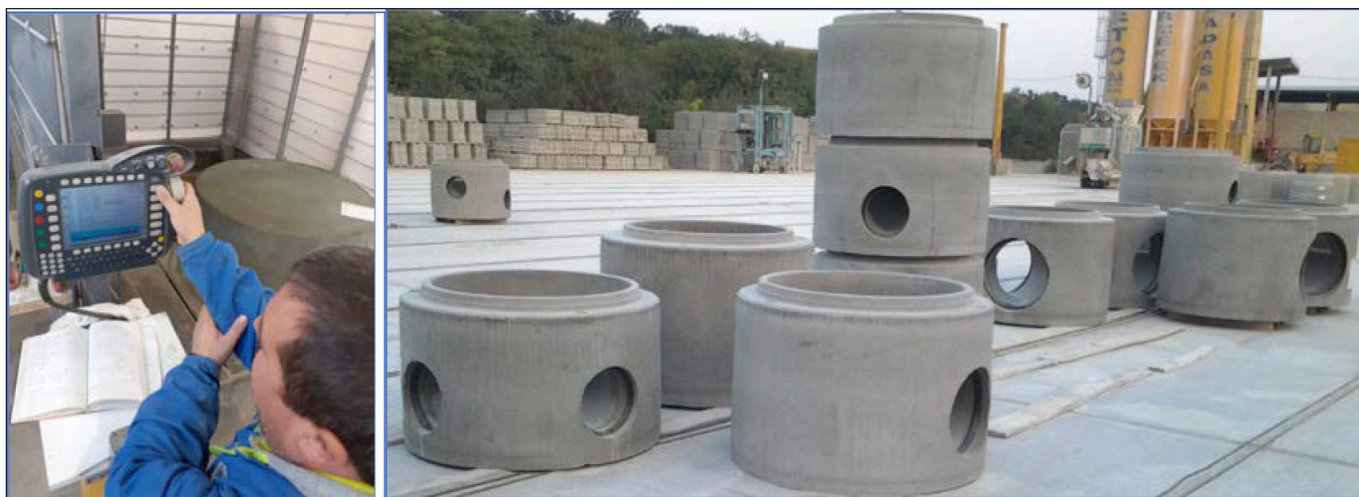
24-25. ábra: A KCP készüléken (baloldali ábrán) a gépkezelő csökkenti a marás előtolását, mely főként a jobboldali ábrán látható, hosszú marásidejű aknáknál válik szükségessé
