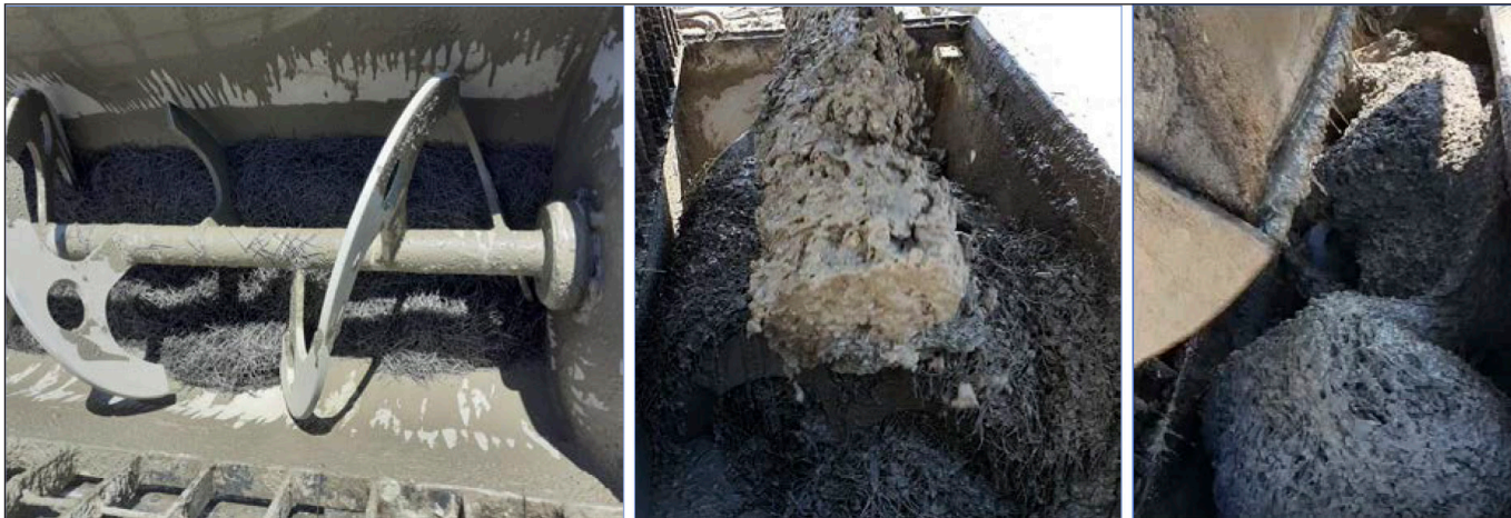
27-29. ábra: A Bobcat munkagép keverőadapterével gyorsan homogenizálható a 125 kg/m 3 acélszál
