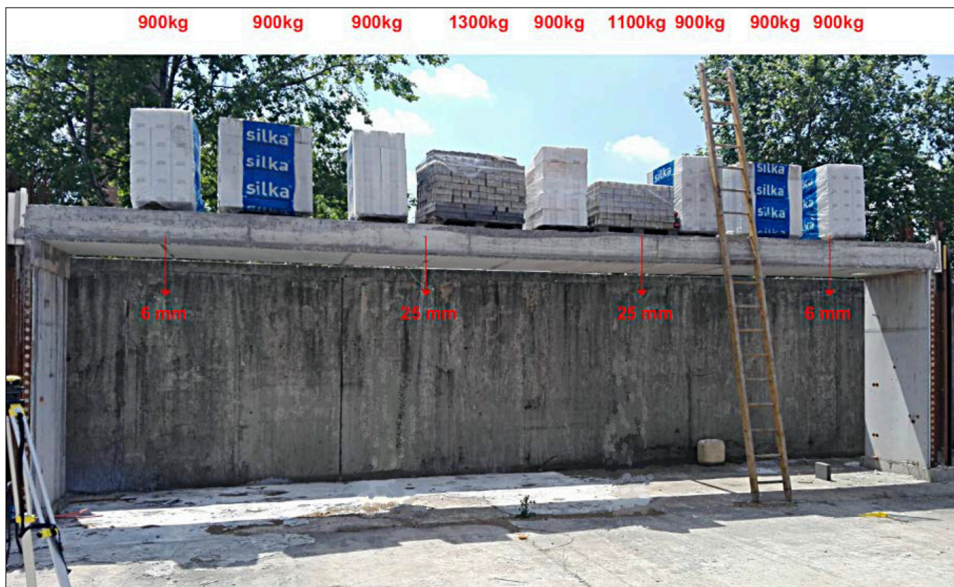
16. ábra: Födém próbaterheléses vizsgálata
